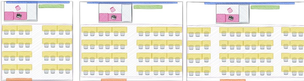
Figure 8. Rapport largeur/profondeur de gauche à droite : Ratio L/P 0,9, 1,3, 1,5.
