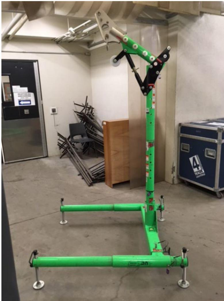
Photo 9. Exemple d'une potence et base fixe de potence
